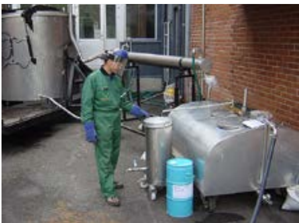
Aromel Oy:n tisluslaitteistolla tislataan minttuöljyä.
