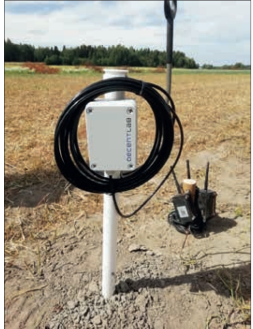
Pohjaveden havaintoputki ja kosteusmittarit pellolla.
