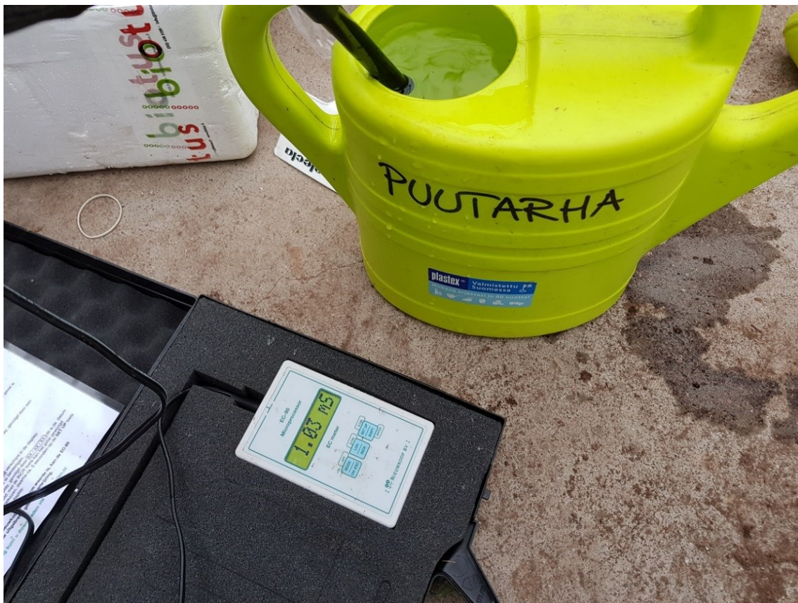
Kuva 5. Kastelussa antoliuos tehtiin käsin mittaamalla oikea määrä lannoitetta johtokykymittarin avulla.
