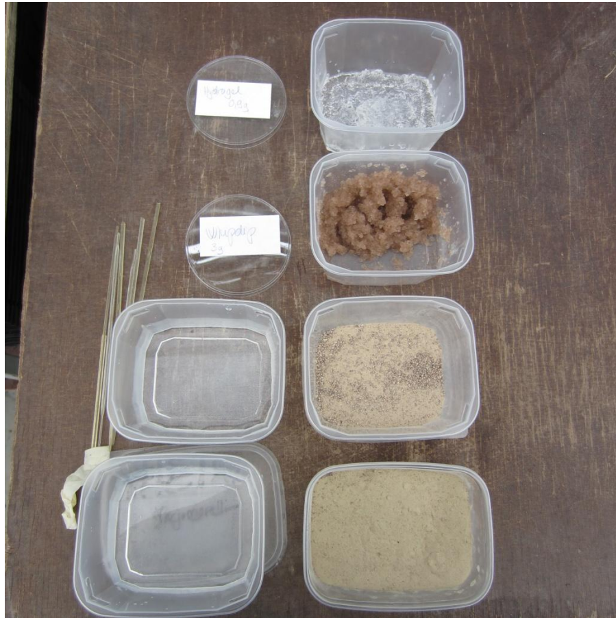
Kuva 3. Kokeessa käytetyt valmisteet. Järjestyksessä ylhäältä alas puhdas geeli, geelimäinen mykorritsavalmistete, hieta, jauhemainen mykorritsavalmistete
